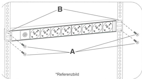
Aufbau des Geräts im Rack: Stecken Sie vier der mitgelieferten Rackmount-Schrauben (A) durch die Montageösen (B) des Geräts und stecken sie in die Rack-Schienen (s. Schaubild). Vor der Installation muss der Benutzer sicherstellen, dass sich die Rackmount-Schrauben zum Halten des Geräts im Rack eignen.
